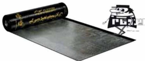
این نوع ایزوگام همانند ایزوگام ساده تولید می گردد با این تفاوت که در ایزوگام فویل دار یک لایه روکش آلومینیوم نازک جایگزین فیلم ژلی اتیلنی گردیده است که سطح عایق را به رنگ نقره ای مبدل می سازد. روکش فویل می توانند در عایق نمودن دیواره های خارجی و بام ها مورد استفاده واقع گردد. از ویژگی های این عایق می توان بازتاب UV خورشید را بر شمرد.
