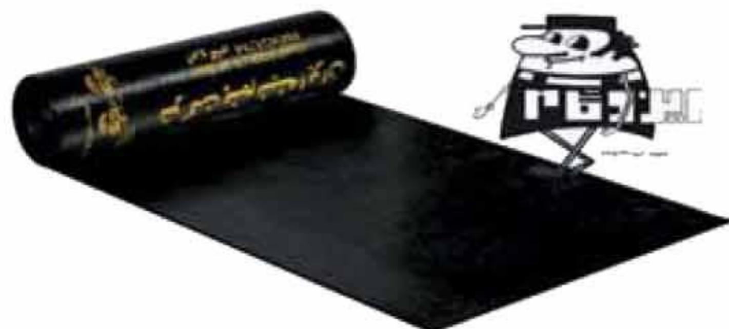
این نوع ایزو گام از دو لایه ی حامل، شامل تیشیوی نخ دار با نخ های شیشه و پلی استر تشکیل می گردد. نوع ساده آن که بدون روکش تولید می شود دارای یک لایه فیلم پلی اتیلن محافظ می باشد که از چسبندگی عایق در هنگام تردد جلوگیری می نماید. از انواع متداول آن می توان به ایزو گام فویل دار (با روکش فویل) نام برد.
